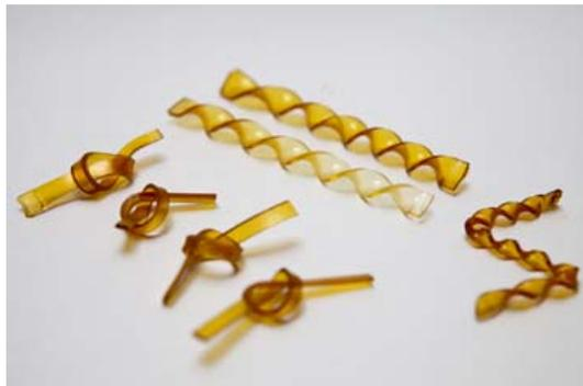
Associer ces atouts dans un même matériau semblait irréalisable, jusqu'à ce que l'équipe de Ludwik Leibler, chercheur CNRS au Laboratoire « Matière molle et chimie » (CNRS/ESPCI ParisTech) et Professeur associé à l'ESPCI, conçoive une nouvelle classe de composés capable de ce tour de force. Réparable et recyclable, ce matériau inédit est façonnable, de manière réversible et à volonté, à haute température. Et de façon
